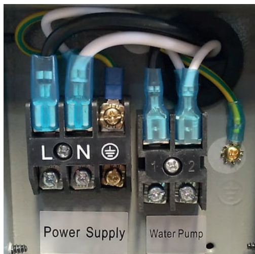
Terminais 1 e 2: Saída de energia elétrica para a motobomba 220Vac / 60Hz (até 10A)
